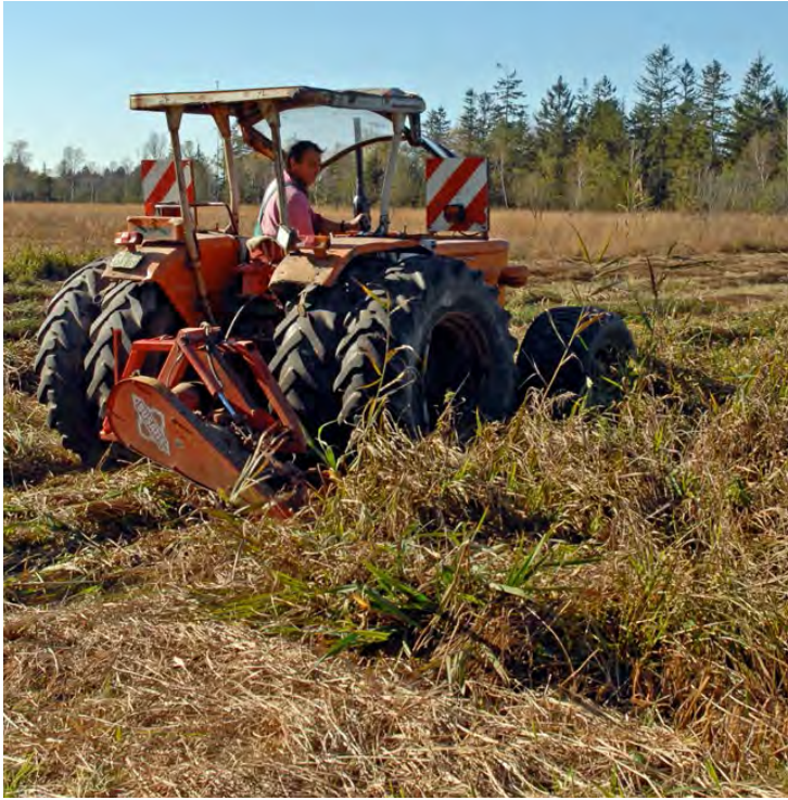
Streumähd mit Zwillingsreifen und Messerbalken – schont Boden und Tiere
