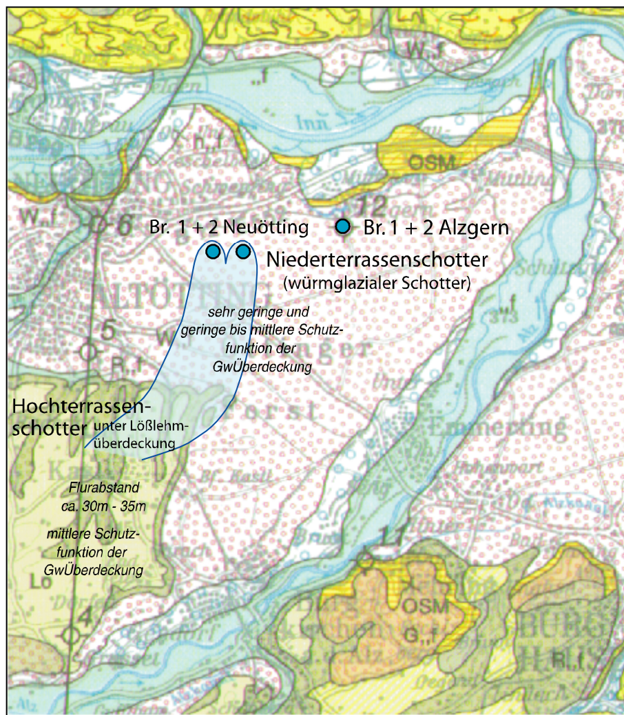
Abb. 5/2b: Geologische Situation mit Schutzfunktion der Grundwasserüberdeckung
