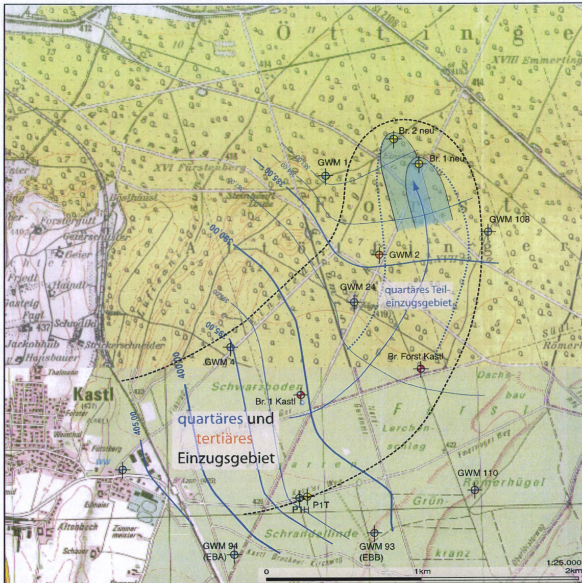
Abb. 5/1: Grundwassersituation und Einzugsgebiet
