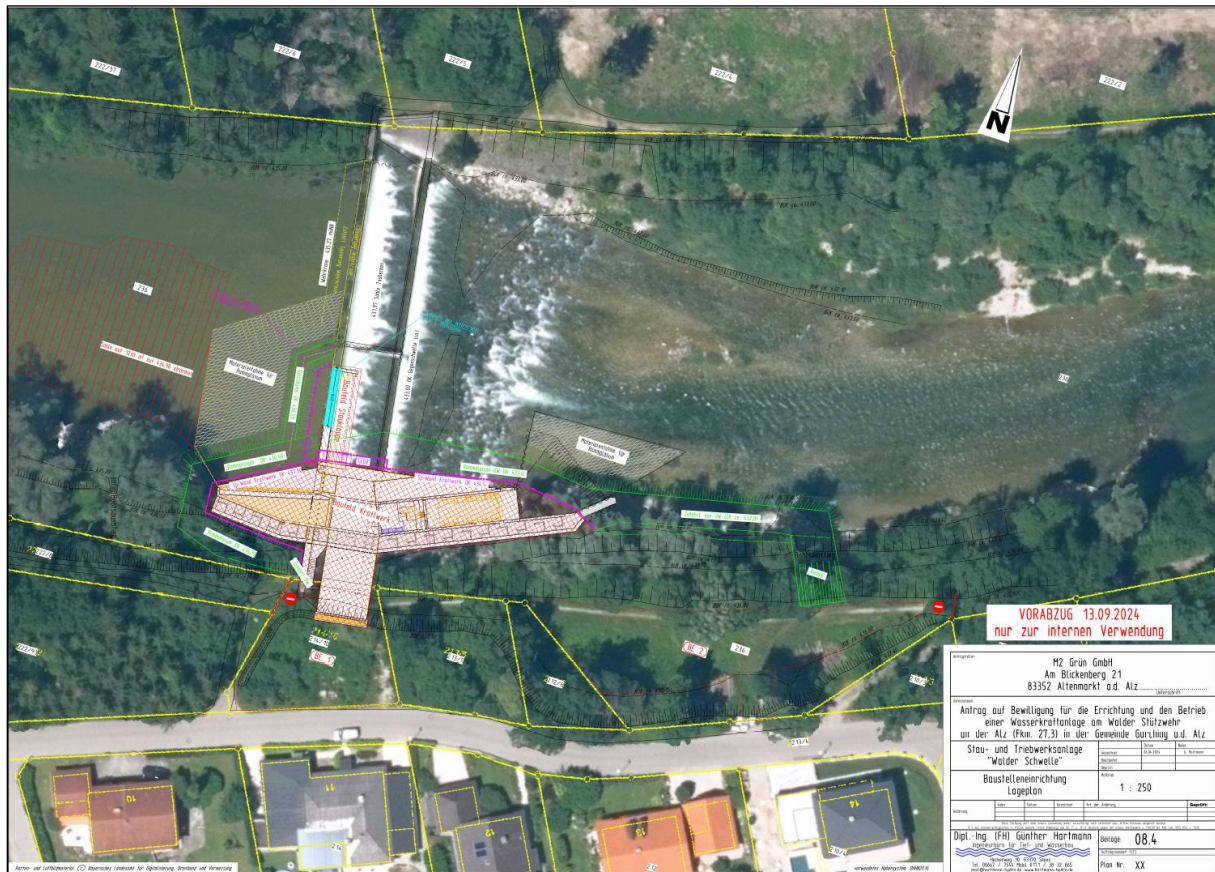
Abb. 1 Walder Schwelle mit Kraftwerksplanung am rechten Ufer bei Wald a.d. Alz
