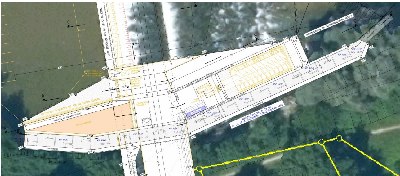
Abbildung 10: Übersicht Fischaufstieg (Planwerk Ingenieurbüro Hartmann 2025).
